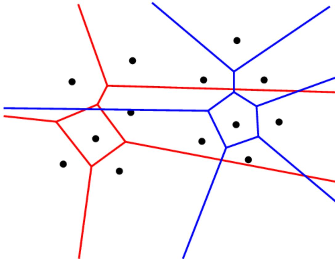
**Merge:** Verbindung der Diagramme durch einen Kantenzug
